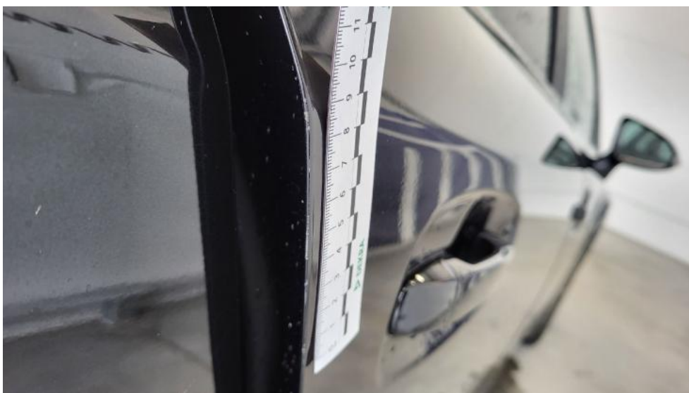
Fot. 50. Drzwi tylne P - Rysa/odprysk 1
