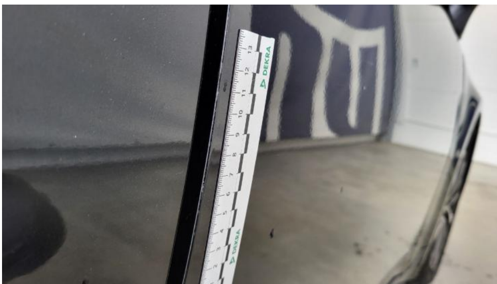
Fot. 48. Drzwi przednie P - Rysa/odprysk 1
