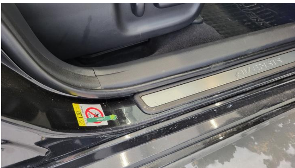
Fot. 52. Próg P - Wgniecenie/odkształcenie 1
