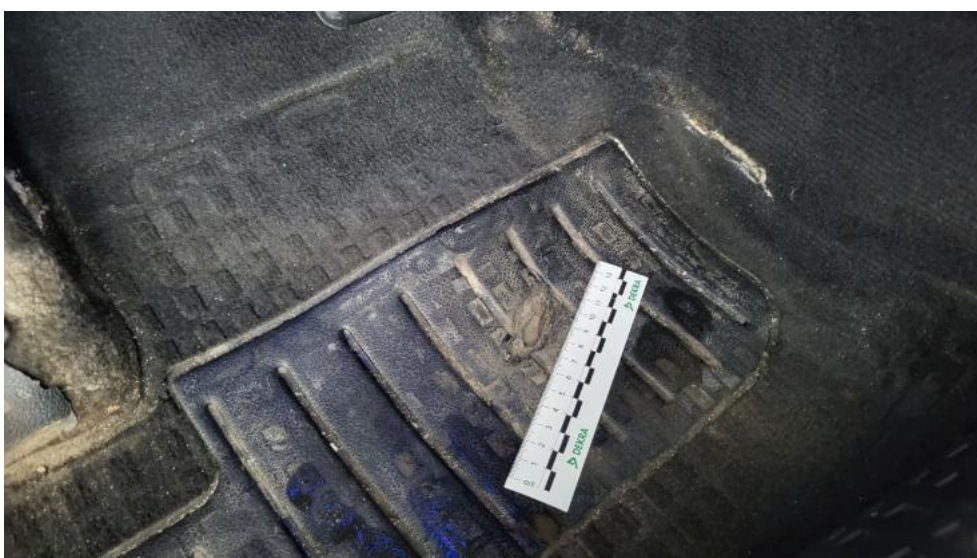
Fot. 92. Wykładzina podłogi - Pęknięcie/rozerwanie 1
