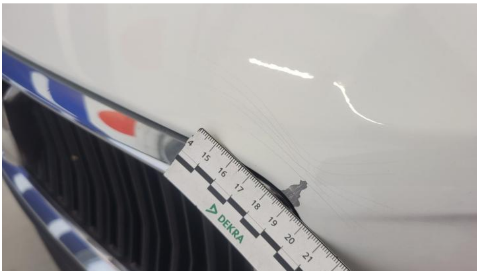
Fot. 45. Zderzak - Pęknięcie/rozerwanie 2
