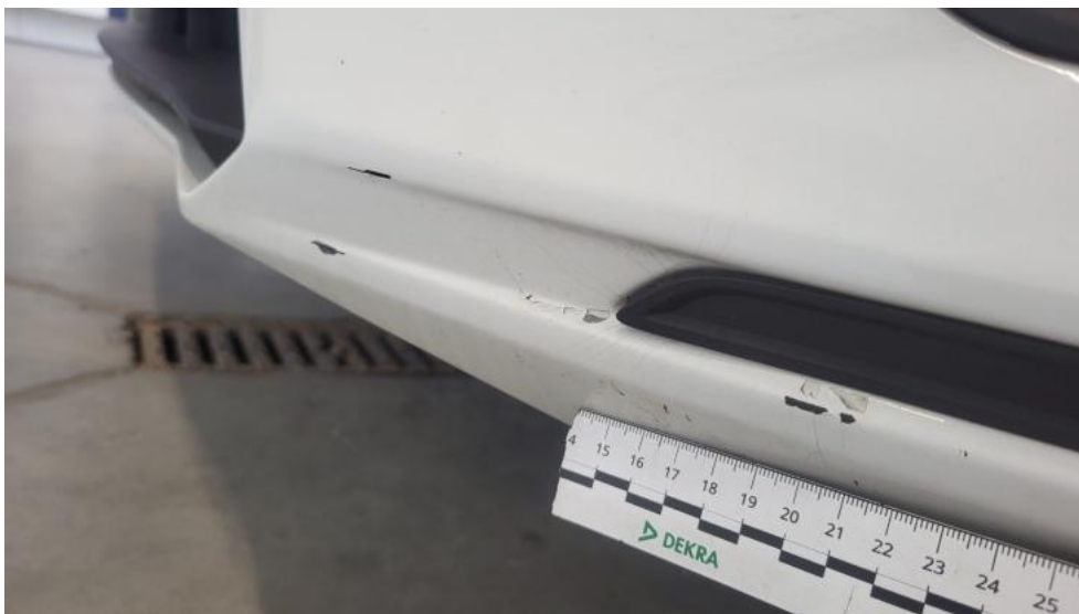
Fot. 43. Zderzak - Rysa/odprysk 1
