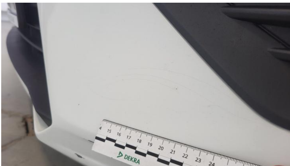
Fot. 44. Zderzak - Pęknięcie/rozerwanie 1
