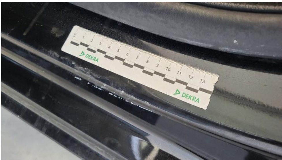
Photo 75. Próg L - Rysa/odprysk 1
