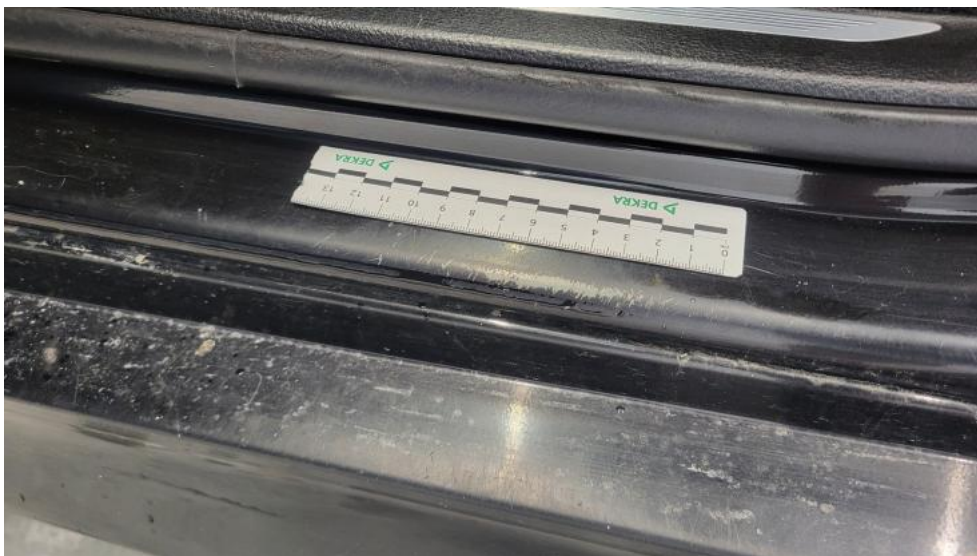
Fot. 79. Próg L - Rysa/odprysk 1
