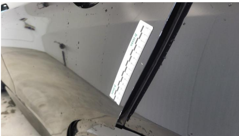
Fot. 76. Drzwi tylne L - Rysa/odprysk 1
