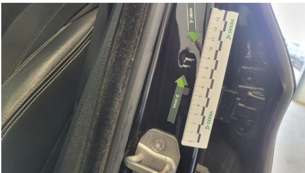
Fot. 80. Słupek środkowy L - Wgniecenie/odkształcenie 1
