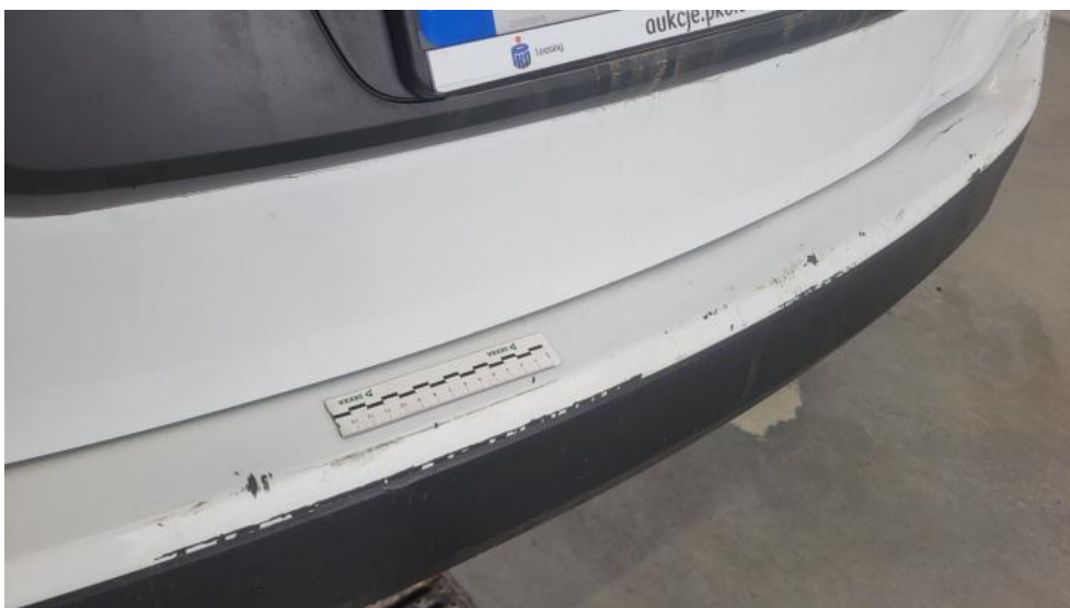
Fot. 76. Zderzak tylny - Rysa/odprysk 2
