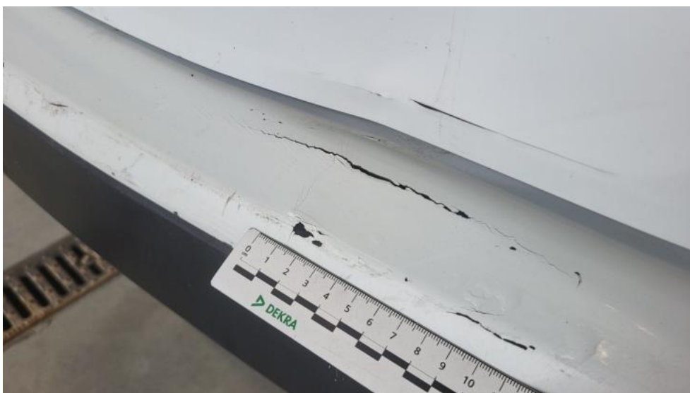
Fot. 80. Zderzak tylny - Pęknięcie/rozerwanie 2
