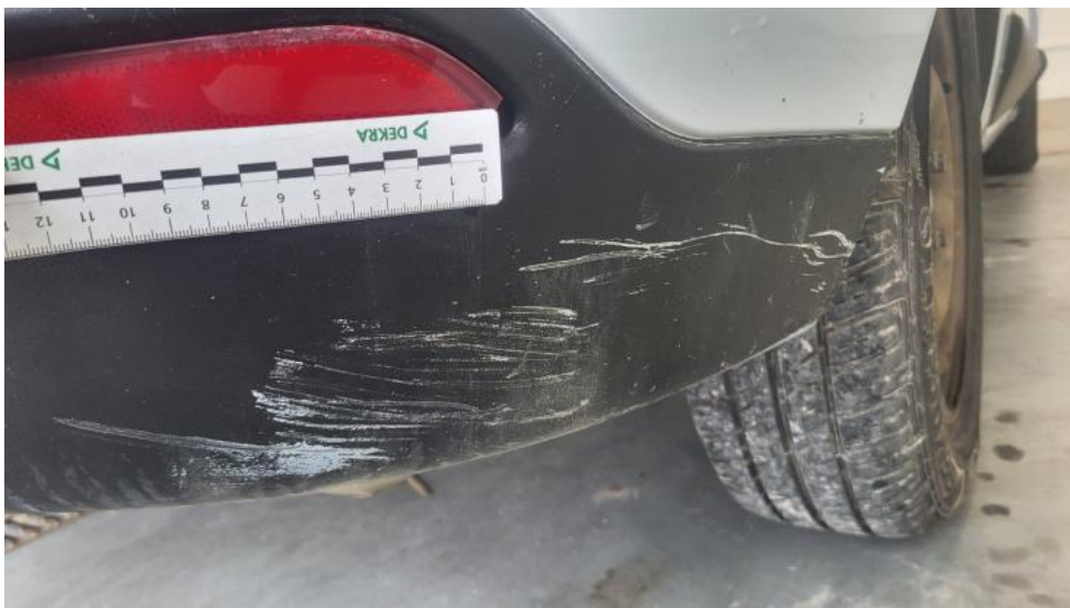
Fot. 82. Zderzak tylny cz dolna - Rysa/odprysk 1
