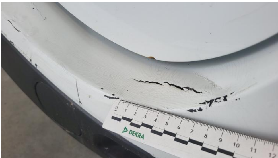
Fot. 79. Zderzak tylny - Pęknięcie/rozerwanie 1
