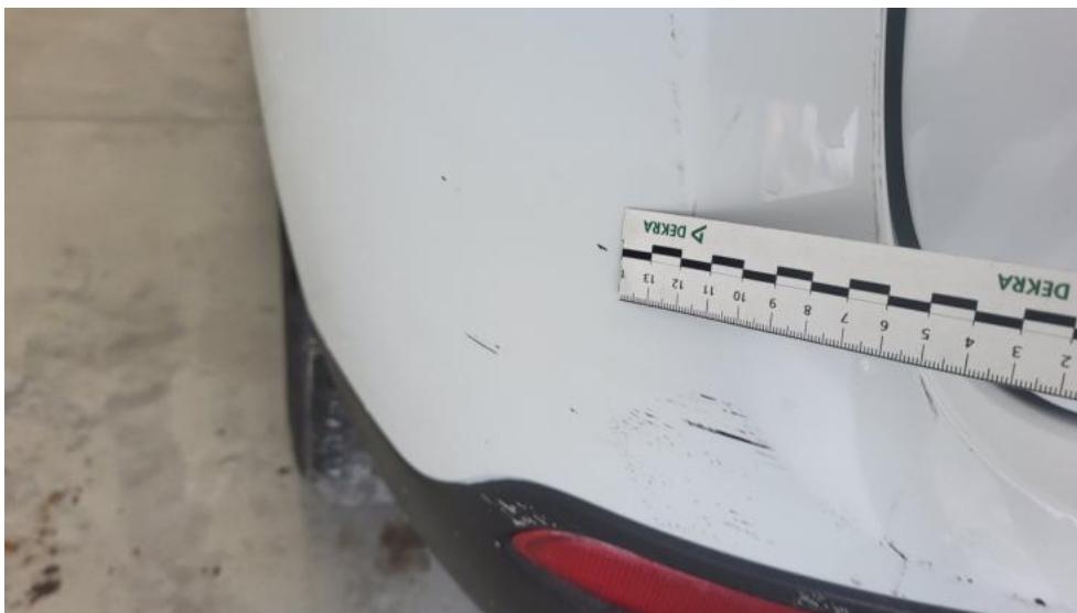
Fot. 75. Zderzak tylny - Rysa/odprysk 1
