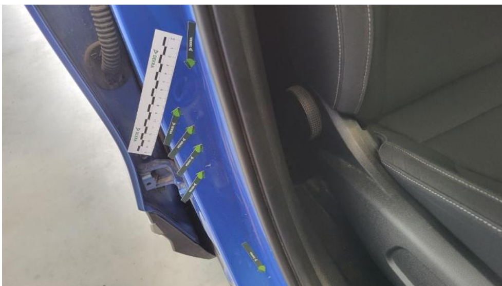
Fot. 46. Słupek środkowy P - Wgniecenie/odkształcenie 1
