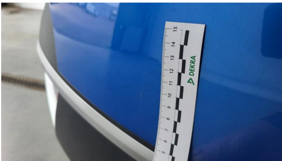
Fot. 51. Zderzak tylny cz P - Rysa/odprysk 1
