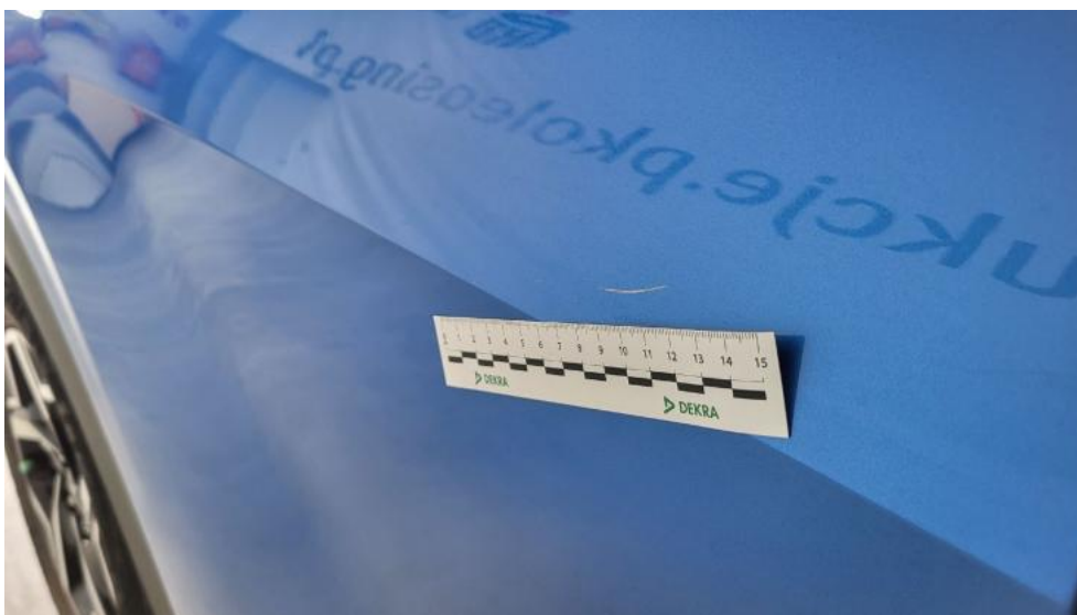
Fot. 44. Drzwi tylne P - Rysa/odprysk 1
