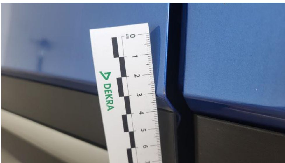
Fot. 53. Drzwi przed L - Rysa/odprysk 1
