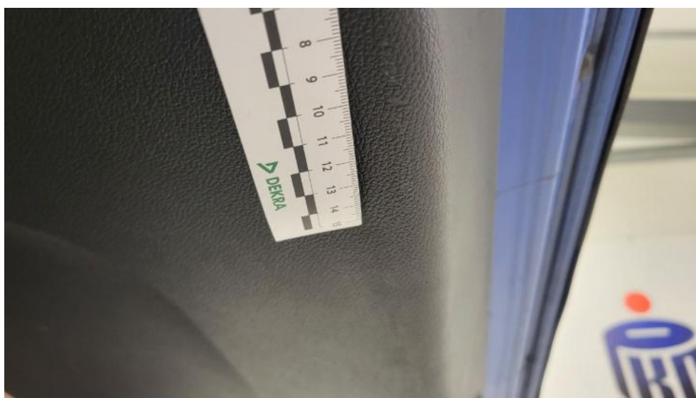
Fot. 64. Wykładzina pokrywy tylnej - Rysa/odprysk 1
