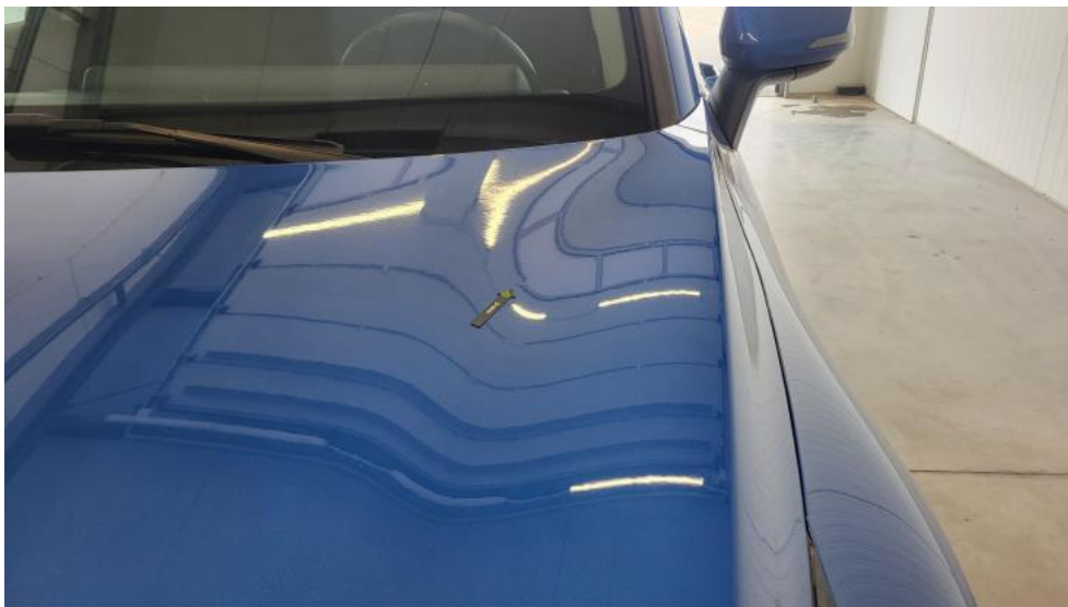
Fot. 41. Pokrywa komory silnika - Wgniecenie/odkształcenie 1
