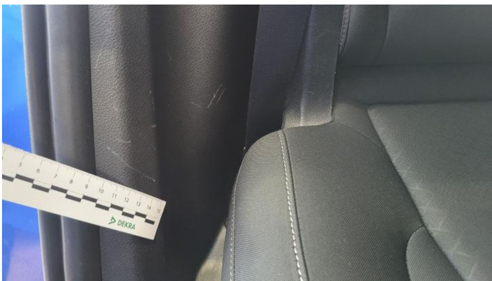
Fot. 62. Wykładzina(y) słupka tylnego P - Rysa/odprysk 1
