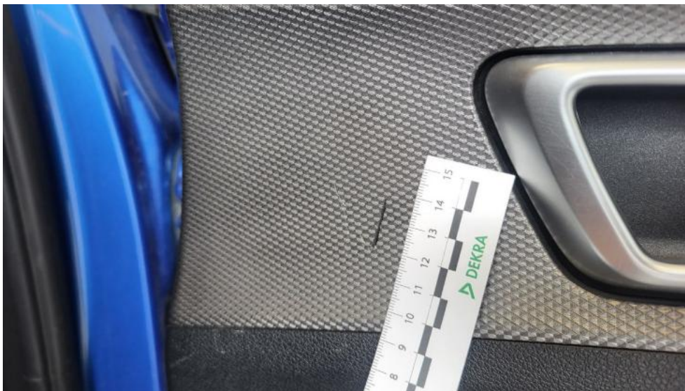
Fot. 61. Tapicerka drzwi tylnych P - Rysa/odprysk 1
