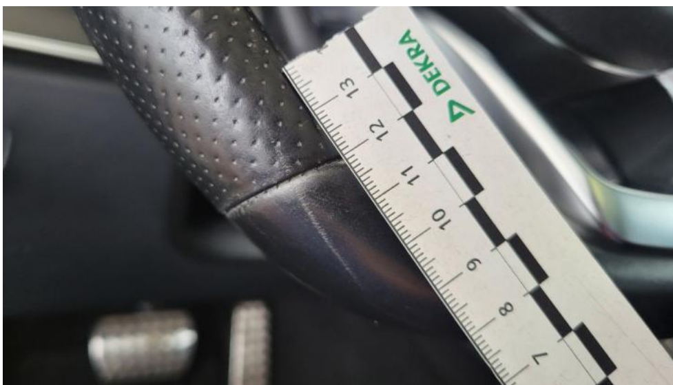
Fot. 73. Koło kierownicy - Rysa/odprysk 1
