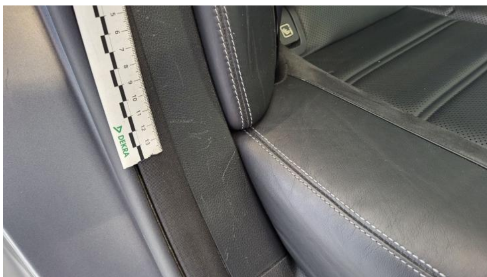
Fot. 82. Wykładzina(y) słupka tylnego P - Rysa/odprysk 1
