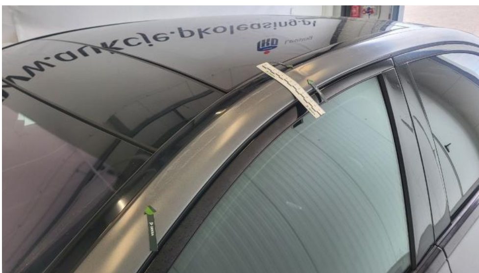
Fot. 68. Słupek przedni L - Wgniecenie/odkształcenie 1
