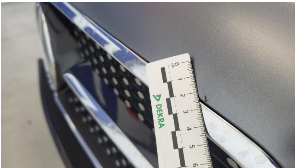
Fot. 43. Zderzak - Rysa/odprysk 2
