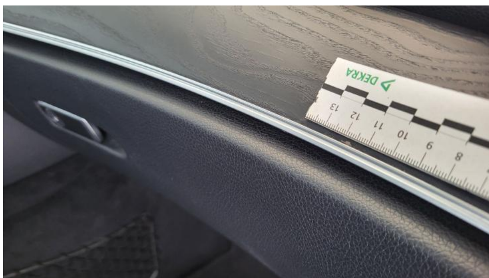
Fot. 72. Deska rozdzielcza - Rysa/odprysk 1
