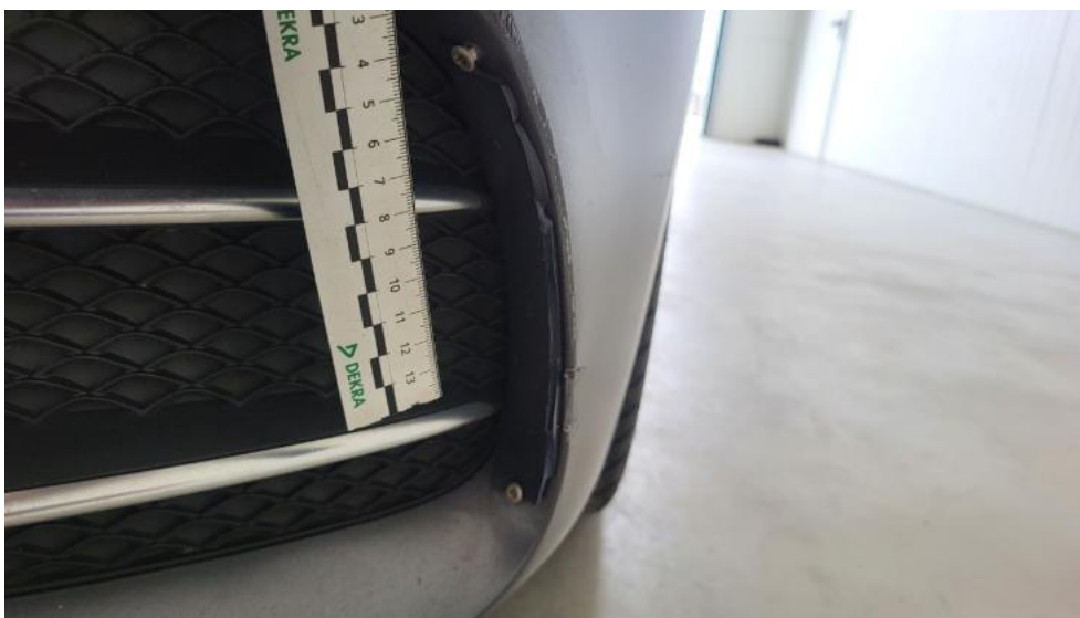
Fot. 39. Kratka/zaślepka halogenu L - Pęknięcie/rozerwanie 1
