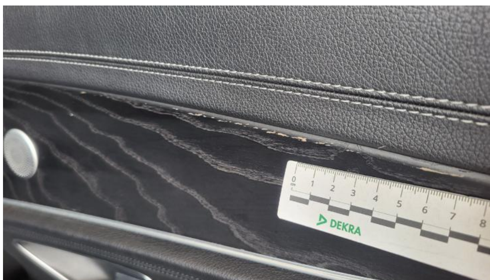
Fot. 80. Tapicerka drzwi tylnych P - Rysa/odprysk 1
