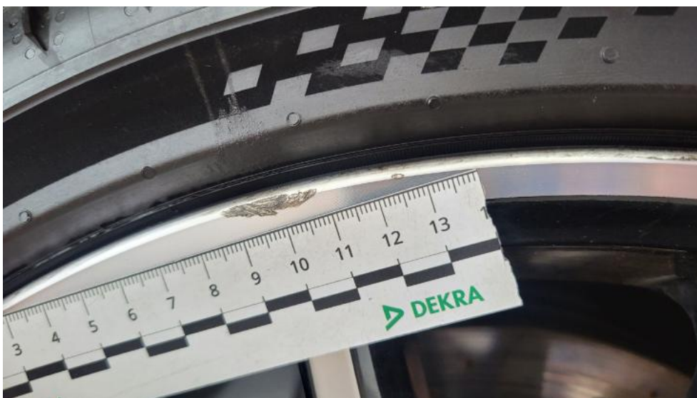
Fot. 44. Felga aluminiowa przednia P - Rysa/odprysk 1
