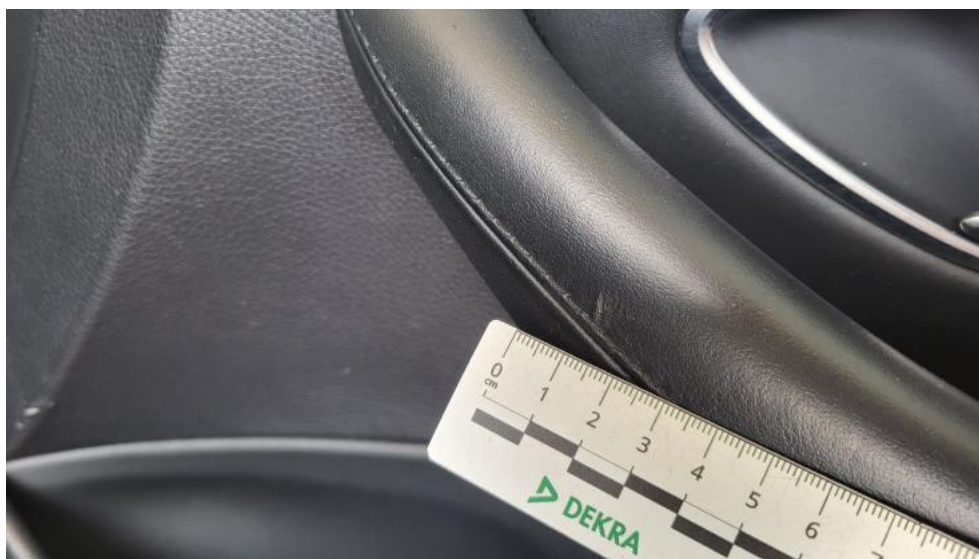
Fot. 81. Uchwyt drzwi prze P - Rysa/odprysk 1
