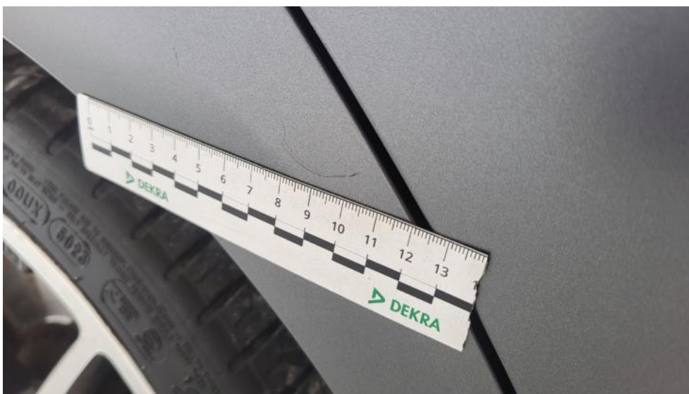
Fot. 49. Błotnik tylny P / Ściana boczna P - Rysa/odprysk 2
