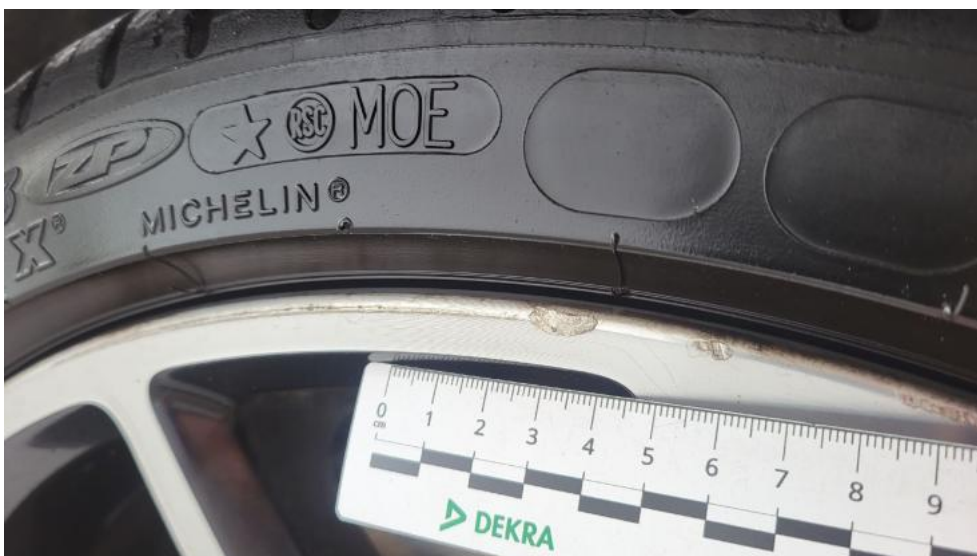
Fot. 52. Felga aluminiowa tylna P - Rysa/odprysk 1
