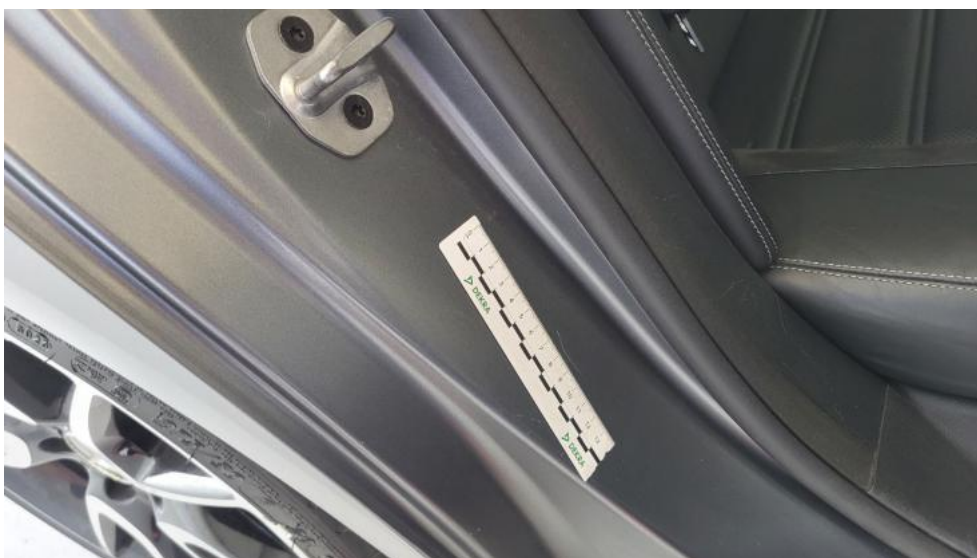
Fot. 48. Błotnik tylny P / Ściana boczna P - Rysa/odprysk 1
