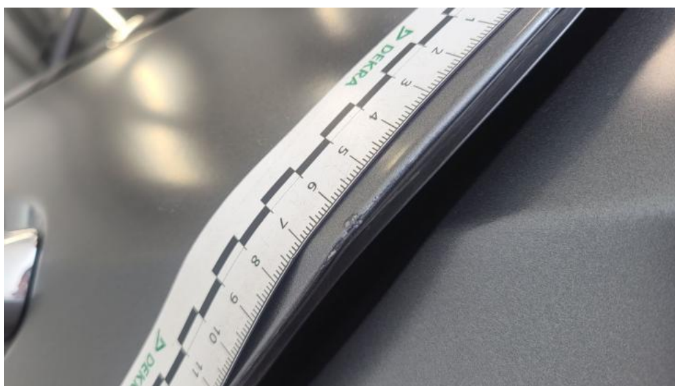
Fot. 64. Drzwi tylne L - Rysa/odprysk 1
