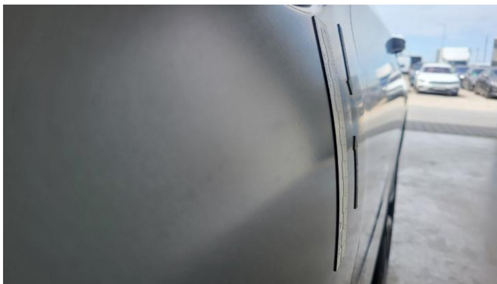
Fot. 63. Drzwi przed L - Wgniecenie/odkształcenie 1
