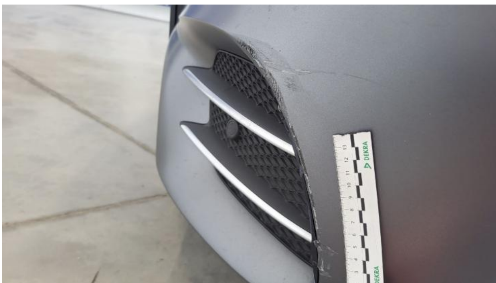
Fot. 42. Zderzak - Rysa/odprysk 1
