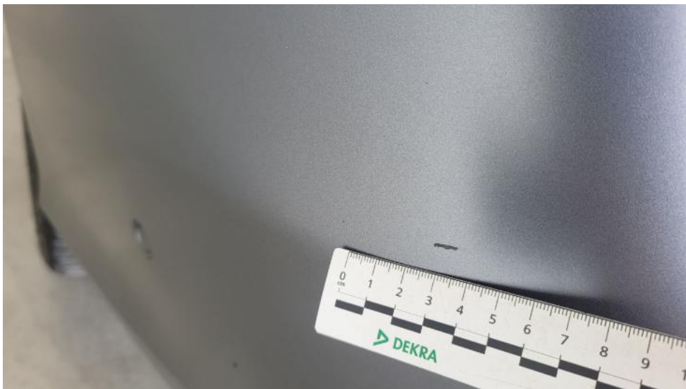
Fot. 55. Zderzak tylny - Rysa/odprysk 2
