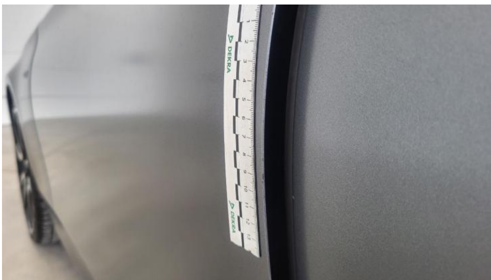
Fot. 62. Drzwi przed L - Rysa/odprysk 1
