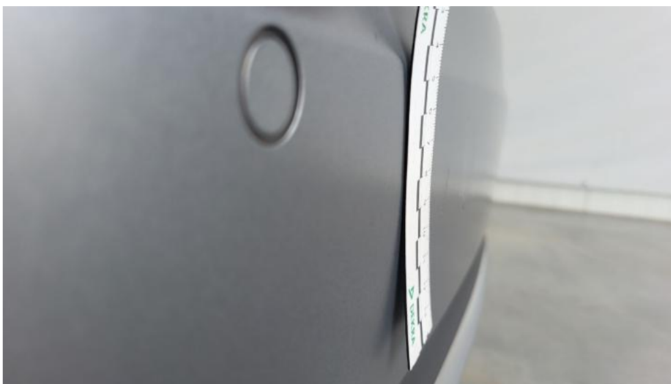
Fot. 57. Zderzak tylny - Wgniecenie/odkształcenie 1
