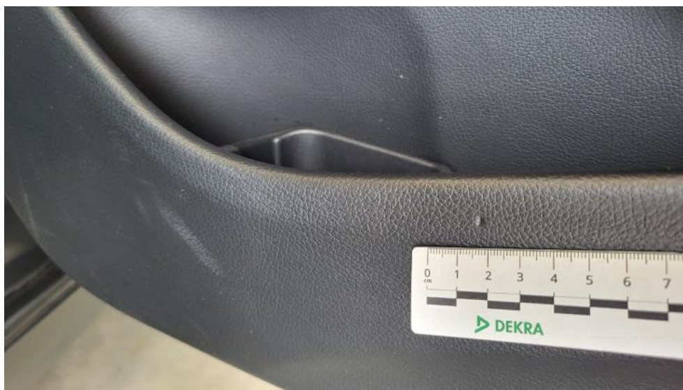
Fot. 79. Tapicerka drzwi przednich P - Wgniecenie/odkształcenie 1
