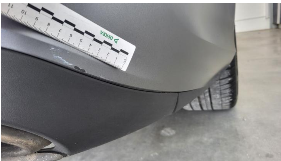
Fot. 54. Zderzak tylny - Rysa/odprysk 1
