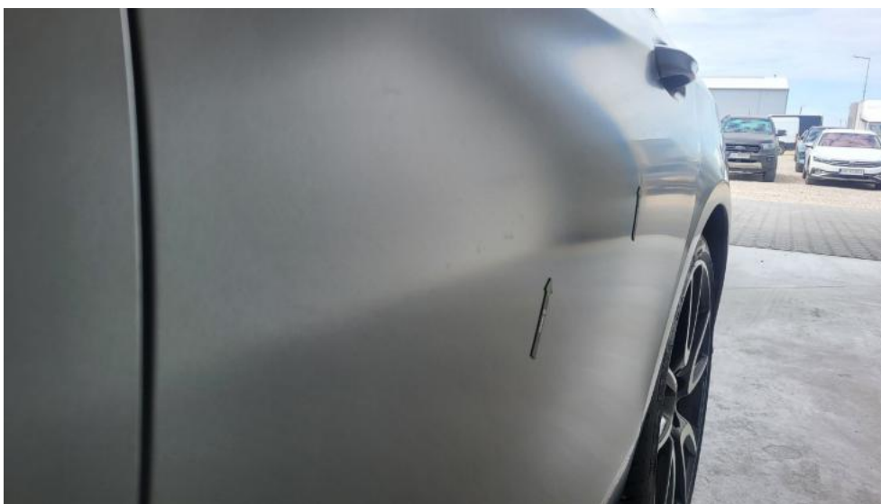
Fot. 65. Drzwi tylne L - Wgniecenie/odkształcenie 1
