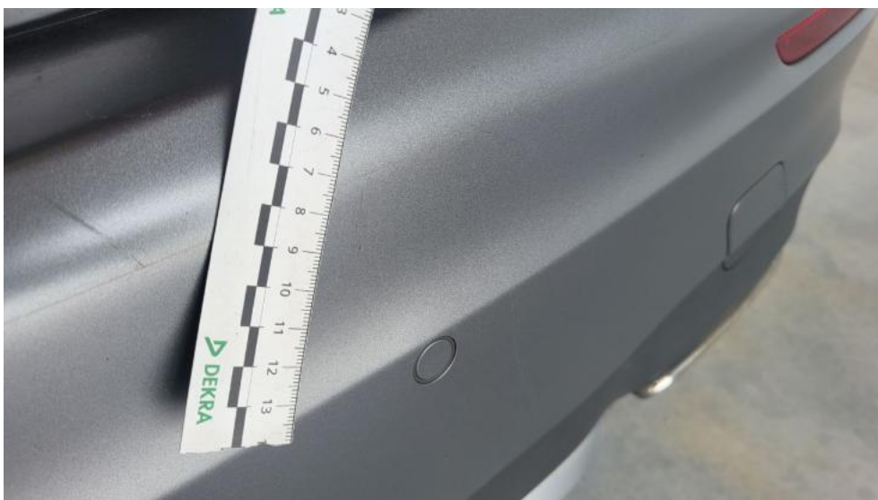
Fot. 56. Zderzak tylny() - Rysa/odprysk 3
