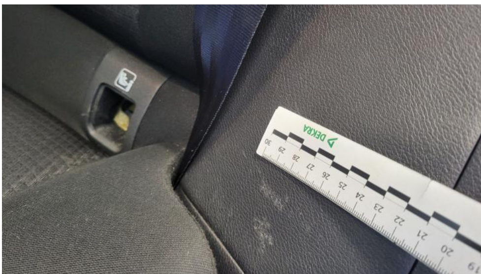
Fot. 84. Wykładzina(y) słupka tylnego L - Rysa/odprysk 1
