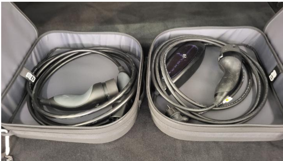
Fot. 35. Przewód ładowania baterii trakcyjnej
