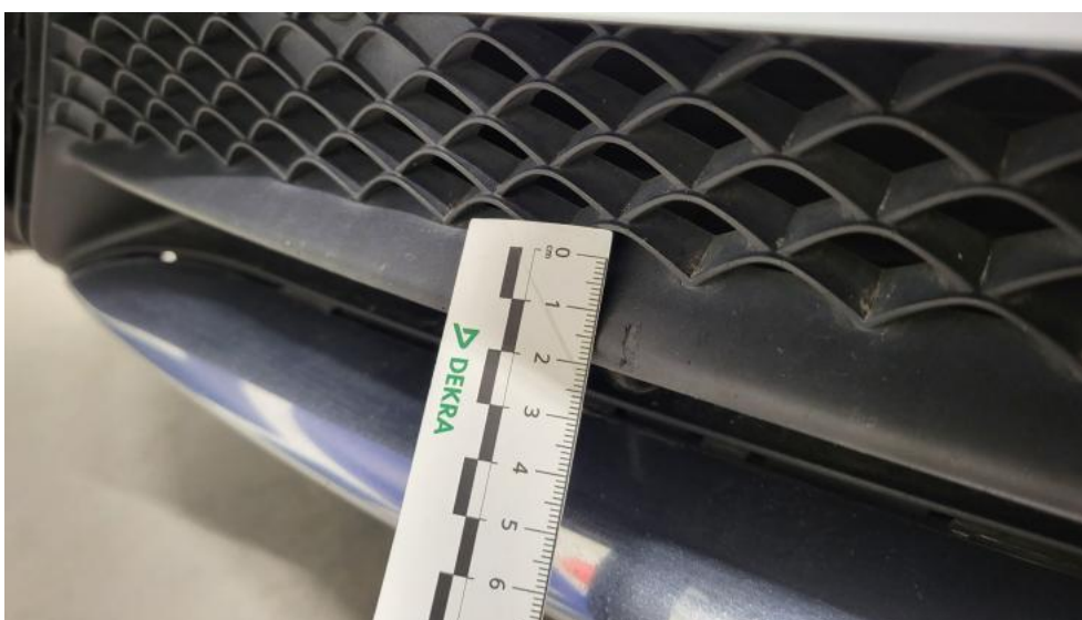
Fot. 46. Krata zderzaka prz. - Rysa/odprysk 1
