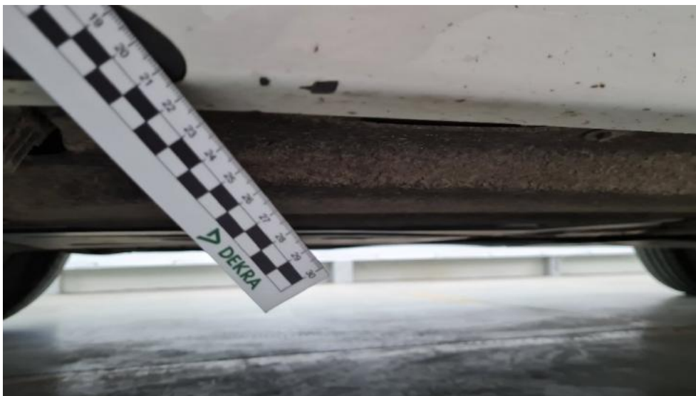
Photo 35. Próg lewy (Rysa/Odprysk)
