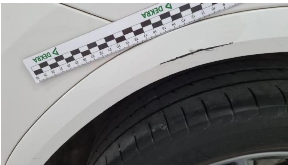
Photo 31. Listwa ściany boczna prawa (Rysa/Odprysk)
