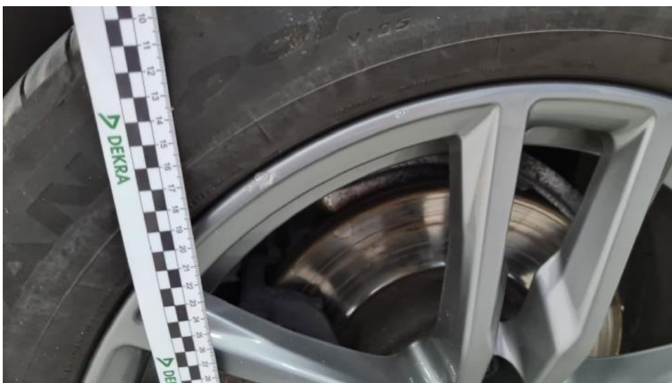
Photo 30. Felga przednia prawa (Rysa/Odprysk)
