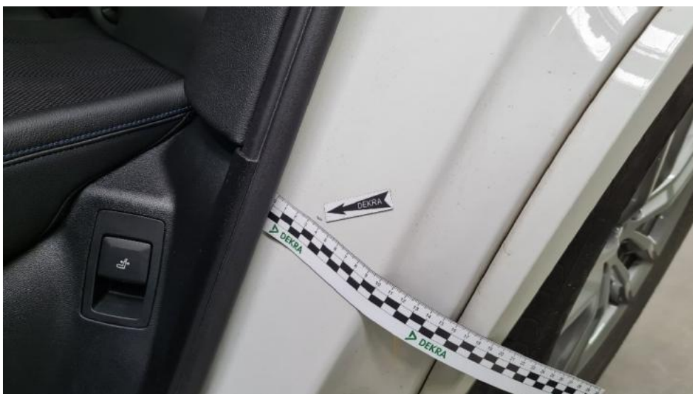
Photo 34. Błotnik tylny lewy/ściana boczna lewa (Rysa/Odprysk)
