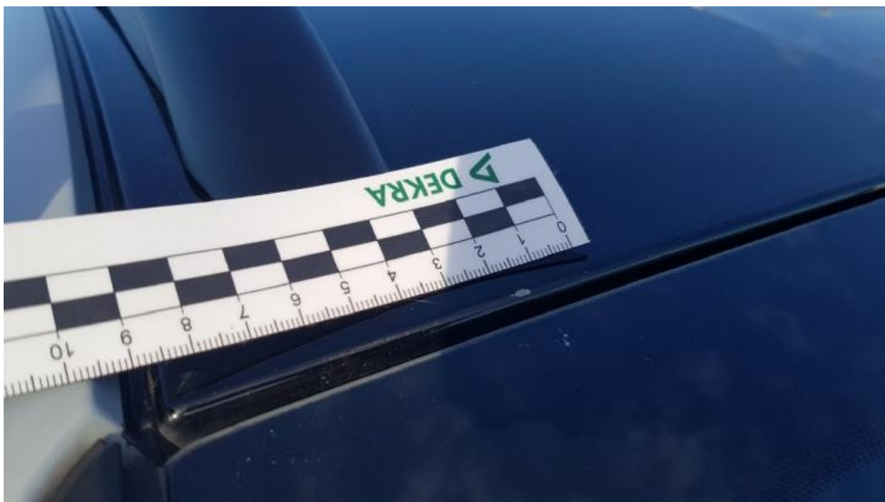
Fot. 33. Dach (Rysa/Odprysk)
